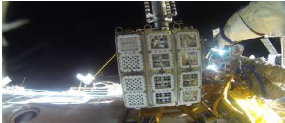
Фиг. 1. В центъра е платформата EXPOSE-R2. Приборът R3DR2 е в нейния горен десен ъгъл. В долната част е модулет „Звезда“ на МКС. В горния десен ъгъл се вижда ръката на космонавта Г. Падалка, а в заден план е космонавта М. Корниенко. (Фотографията е направена на 15 август 2015 г. благодарение на ЕКА и РОСКОСМОС.)
